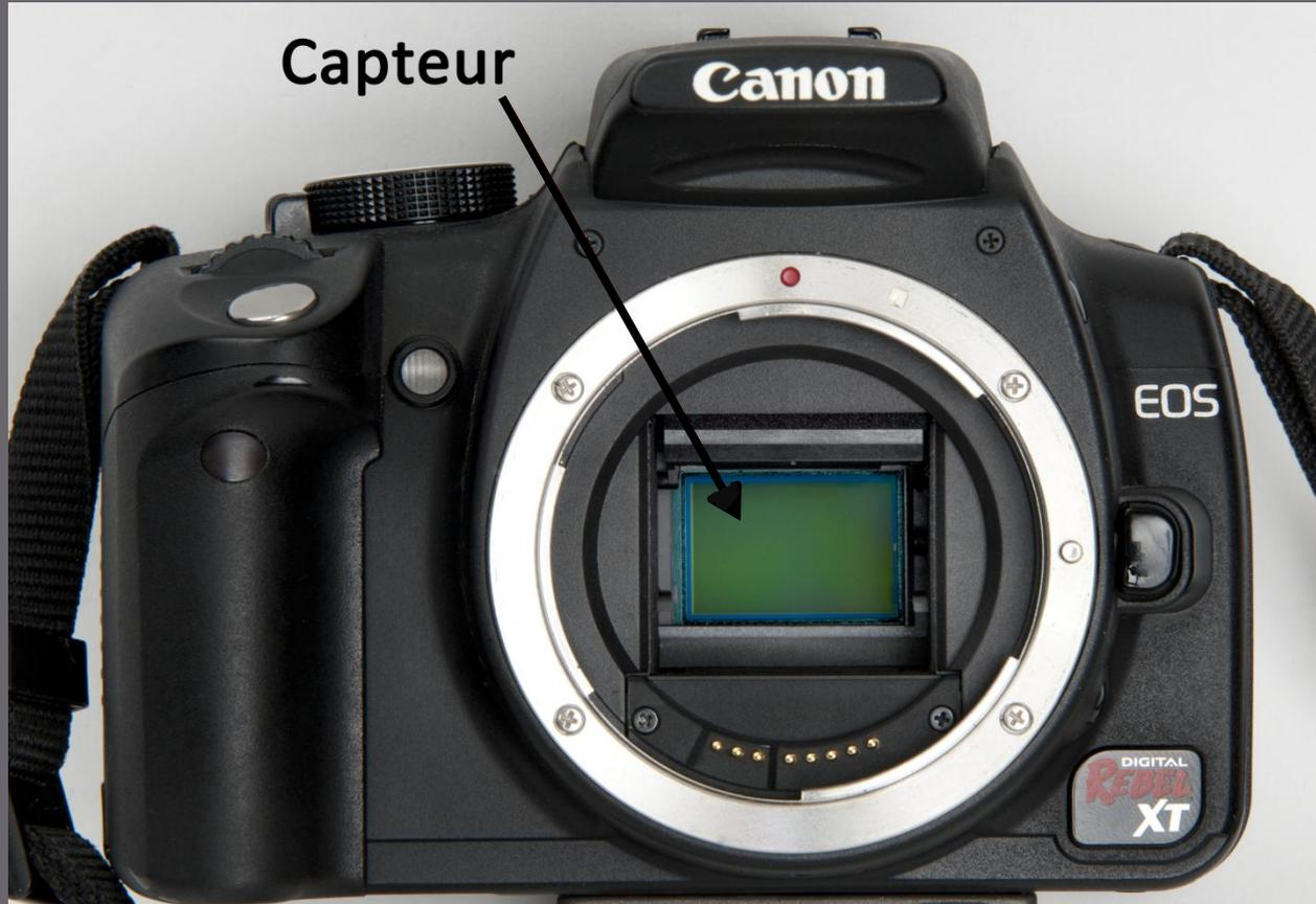
Le capteur est la puce électronique qui convertit l'image lumineuse produite par l'objectif en signaux électriques
