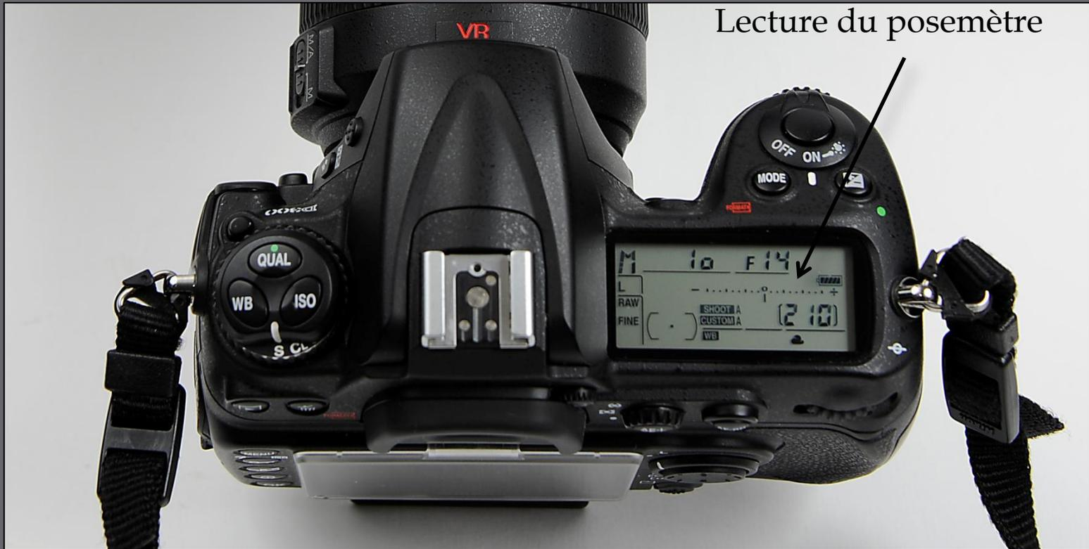
L'appareil photo inclut un posemètre
